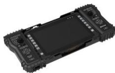
**Abb. 3-1 (alternativ 3-2):** Die Drohnensteuerung RC2143 von MilDef (im Bild mit Panther DS13) steuert herkömmliche und militärischen Drohnen am Boden und in der Luft. (©roda computer)
